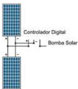
2 paneles solares de 265W
