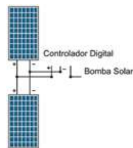
2 paneles solares de 335W
