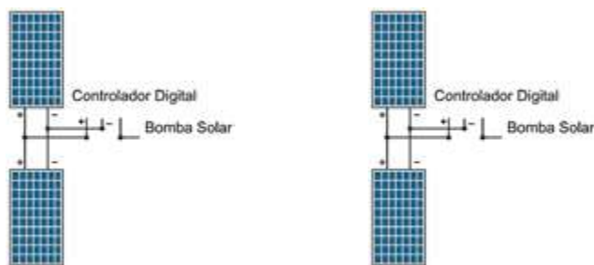
2 paneles solares de 265W
