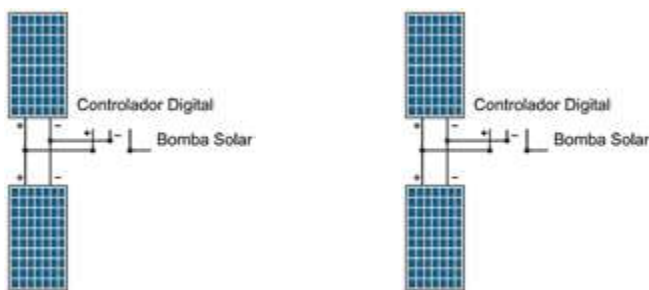
2 paneles solares de 265W
