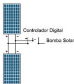
2 paneles solares de 335W
